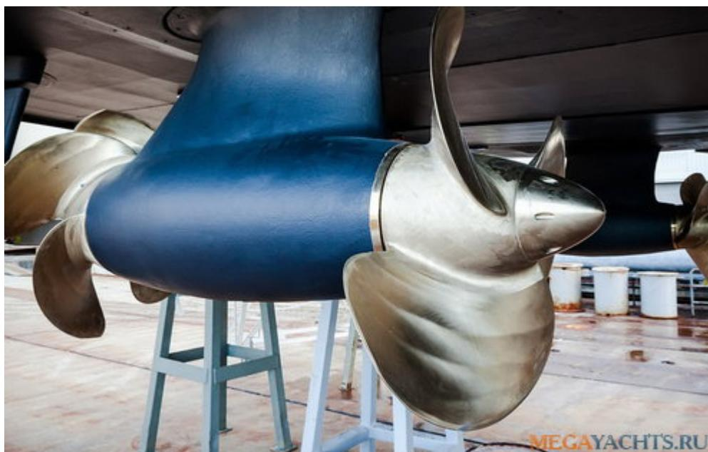
Суперяхта приводится в движение парой дизельных двигателей MAN V12 мощностью по 1800 л.с. совмещенными с POD-приводами Fortjes. Это впервые для яхты такого размера. Высокоэффективные приводы обеспечивают максимальную скорость 21 узел, а вертикальный форштевень создает современный внешний профиль, а также добавляет
