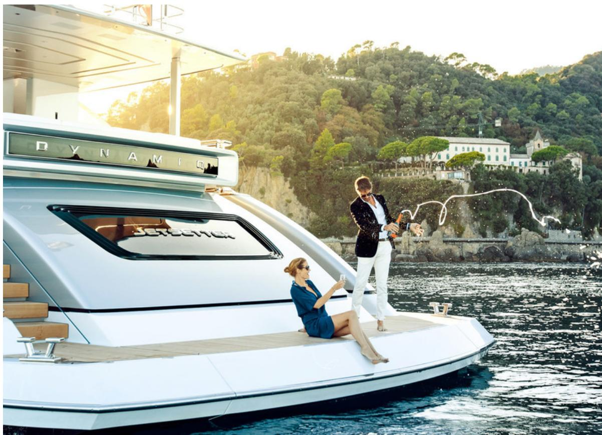
При желании можно разогнать Jetsetter до 21 узла: на «максималке» расход топлива составит 650 л/час. Топливные баки лодки вмещают 25 тыс литров, так что даже на высокой скорости можно гнать, не останавливаясь, более полутора суток. За рулем интегрированного поста управления i-Bridge это не сложно: с помощью двух трекболов и четырех мониторов можно контролировать все, от навигации до систем безопасности и мониторинга.
